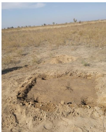
Рисунок 5. Увлажненная опытная площадка (после снятия пленки, через 72 часа).
