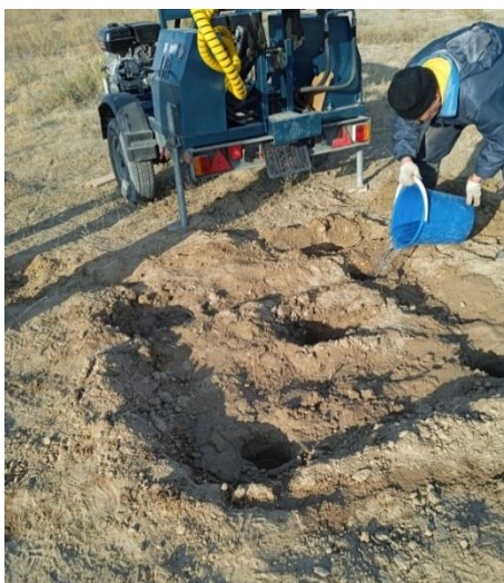
Рисунок 4. Повторное заполнение опытных скважин водой.
